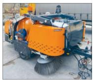
двухколесные оси. Такие уборочные прицепы обычно оснащены собственной энергетической установкой, которая может быть дизельным или бензиновым двигателем, прицепным устройством для соединения с тракторными прицепами, а также системой приводов щёток.
